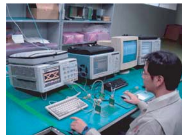
测定现场 用脉冲发生器把高频率模拟脉冲加载到印刷电路板上，在与实际工作条件相接近的条件下，进行高频率传送波形的测量和实机验证，以保证高可靠性。
